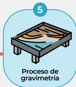
El **oro concentrado del chute** con presencia de otros minerales es trasladado a una **mesa vibratoria** la cual separa el oro de otros minerales por diferencia de pesos, obteniendo un segundo concentrado de oro con menor presencia de impurezas.
