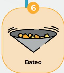
Es un proceso manual de remover y separar el oro de sus impurezas, es la última limpieza, se utiliza un plato hondo similar a un cono, que permite obtener un **concentrado más limpio** y listo para una fundición directa.
