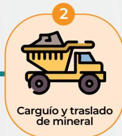
Consiste en recojo del mineral aurífero mediante excavadoras y cargadores frontales en volquetes para su traslado a las plantas de concentración gravimétrica (chutes).
