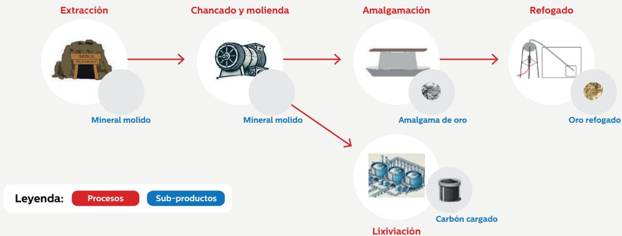
**Ilustración 2:** Flujograma de la cadena de producción de oro en la pequeña minería subterránea
