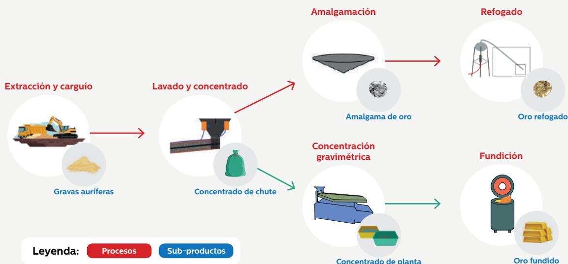
**Ilustración 3:** Flujograma de la cadena de producción de oro en la pequeña minería superficial
