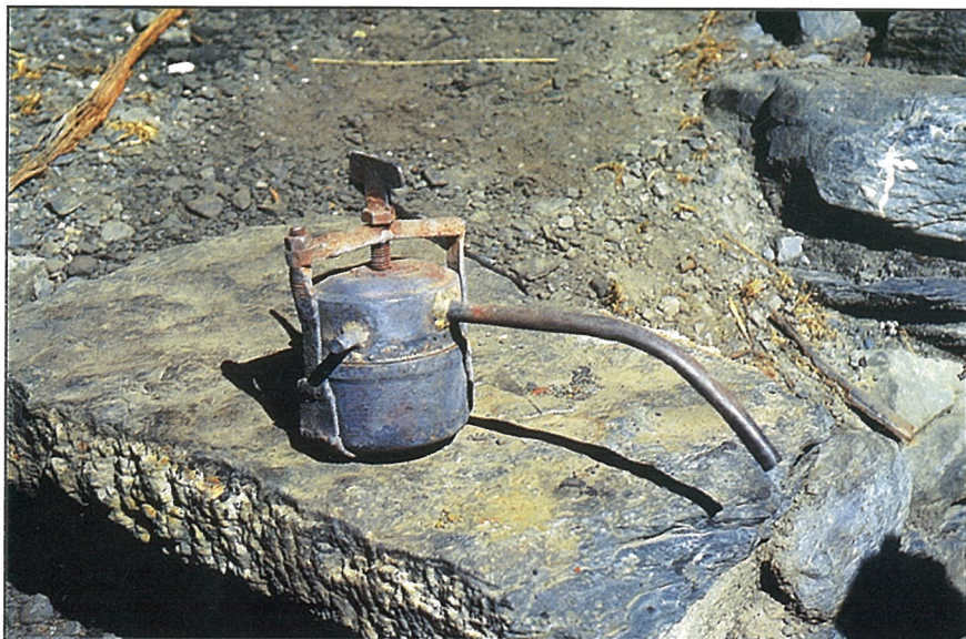
39. Retorta de fabricación rústica hecha de una lámpara de carburo (Coop. La Suerte, Bolivia)
