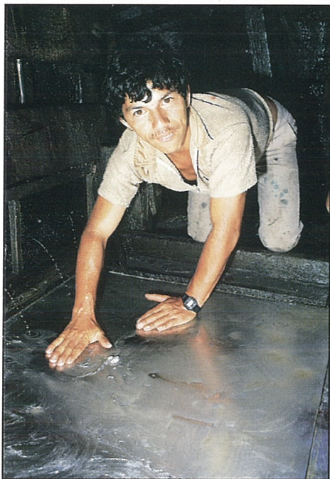
25. Preparación de planchas amalgamadoras (Nariño, Colombia)
