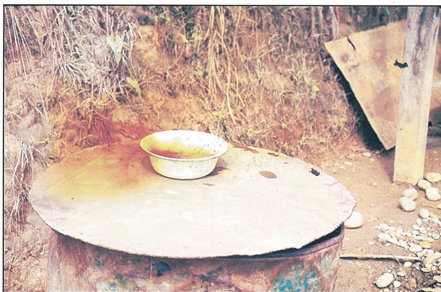
42. Disolución de sulfuros con ácido nítrico (Coop. Huayna Potosí, Bolivia)
