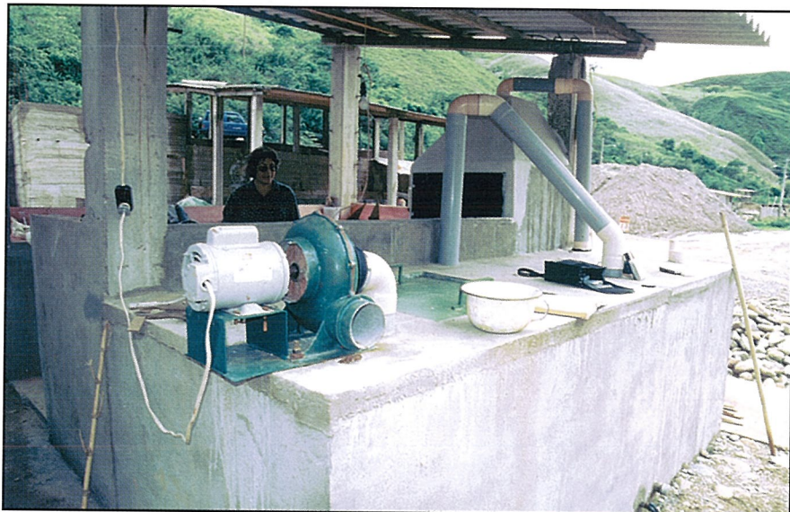
53. Filtro de carbón vegetal y lechada de cal para gases \text{NO}_x (Zaruma, Ecuador)
