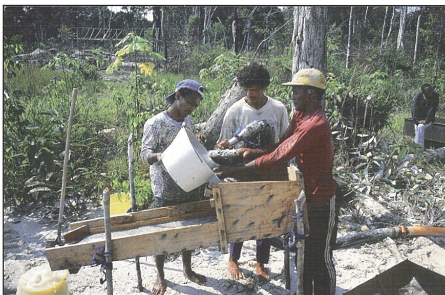
30. Cobrinha (canaleta pequena para enriquecimiento de preconcentrados) (Piririma, Tapajós, Brasil)
