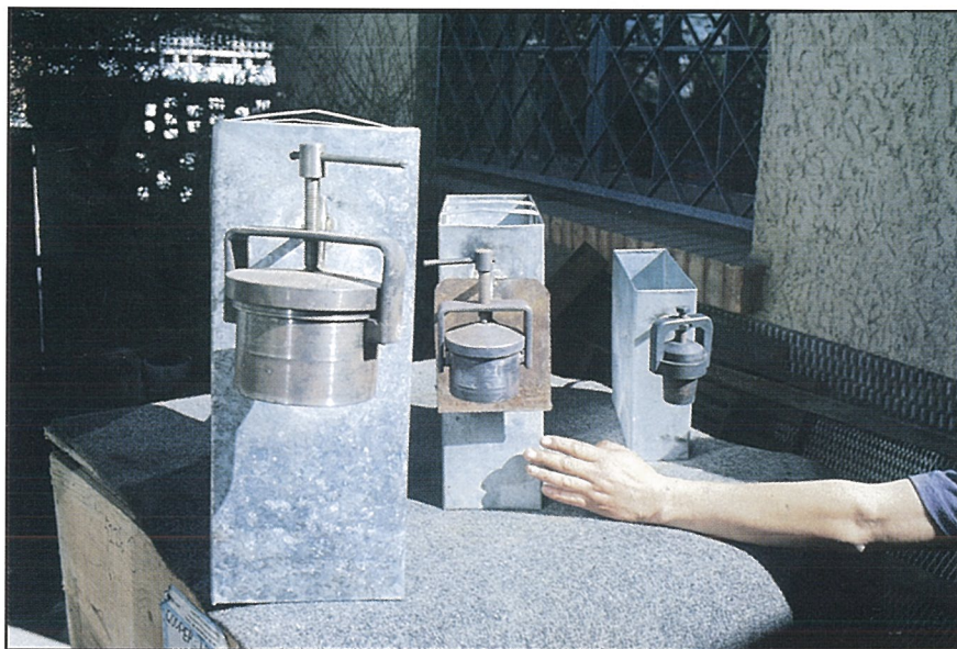
41. Retortas de fabricación local de diferentes tamaños (PMSC, Ecuador; MEDMIN, Bolivia)
