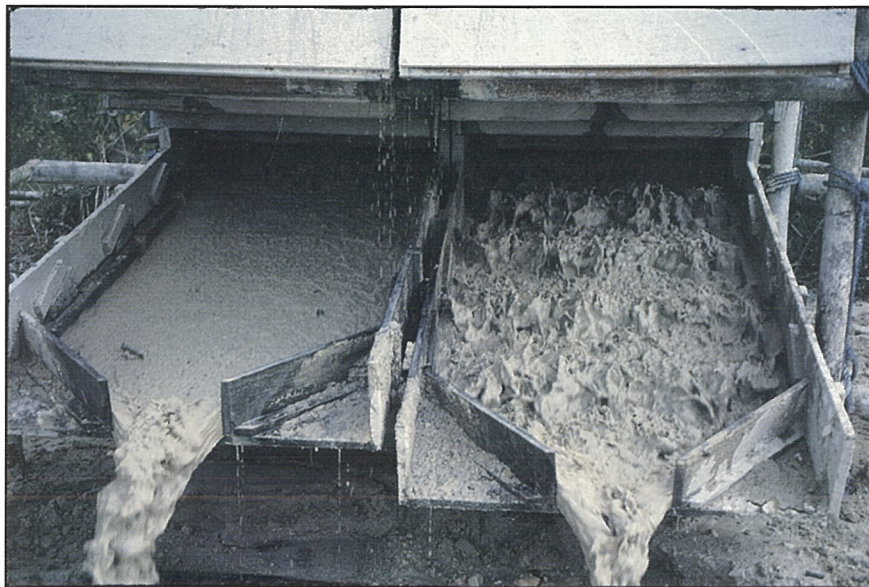
29. Caixa (canaleta) experimental; alta turbulencia: tradicional, baja turbulencia: modificada (Piririma, Tapajós, Brasil)
