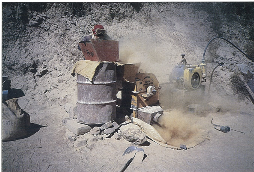
45. Emisión de polvo de cuarzo por molienda en seco (Mina Machacamarca, Bolivia)
