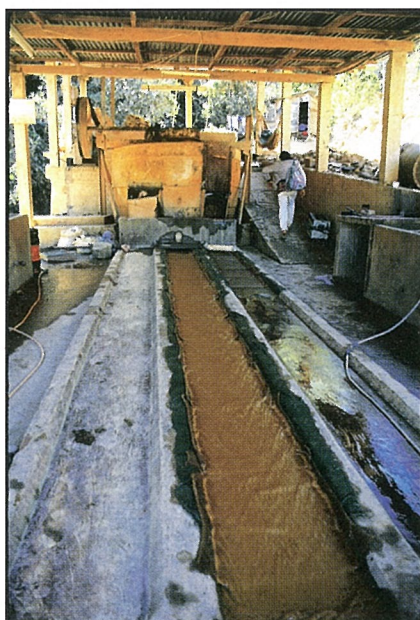
28. Canelón (canaleta con cubierta de bayetas) (Zaruma, Ecuador)
