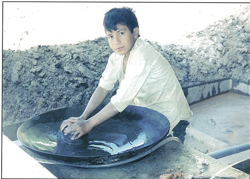
15. Amalgamación manual (dentro de una batea metálica grande) (Zaruma, Ecuador)
