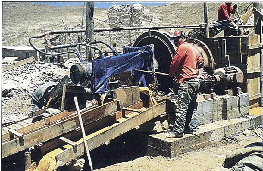
31. Canaletas con diferentes pisos (alfombras, metal expandido) para diferentes tamaños de carga clasificados por un tromel en la salidad de un molino a bolas (Coop. La Libertad, Bolivia)
