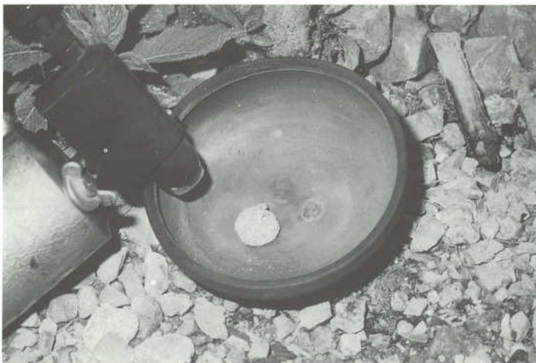
Destilación de amalgama en circuito abierto en un plato de cerámica. Como fuente de calor sirve un soplete de soldar a bencina. Guaysimi, Ecuador.
