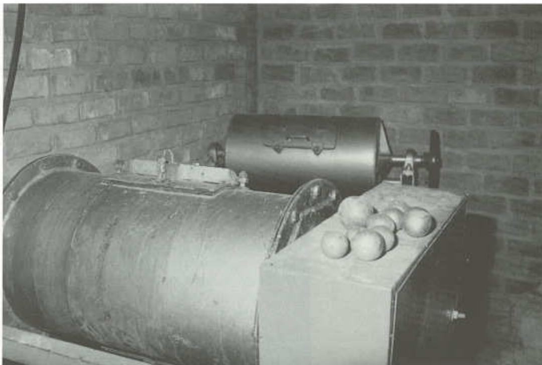
Trómel de amalgamación accionado con motor eléctrico. Son visibles las bolas de acero que sirven para el abatanado de mercurio. Planta de beneficio en Portovelo, El Oro, Ecuador.
