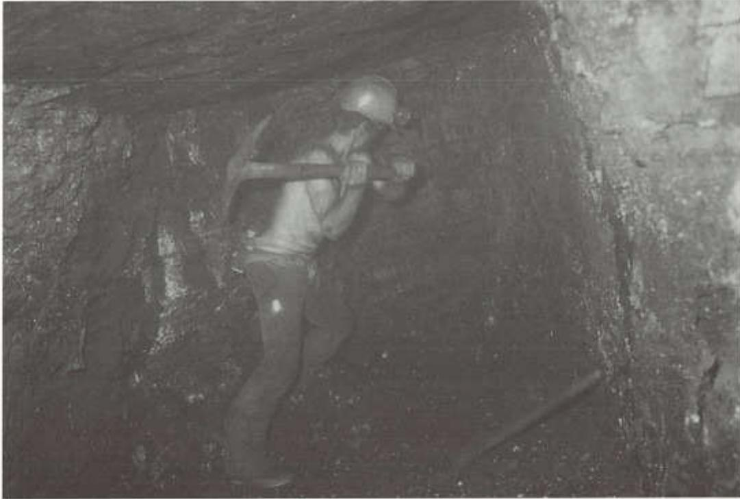
Explotación manual de carbón con pico en el avance de parte de un piso. Minería del carbón en la región de Río Checua, Cundinamarca, Colombia.
