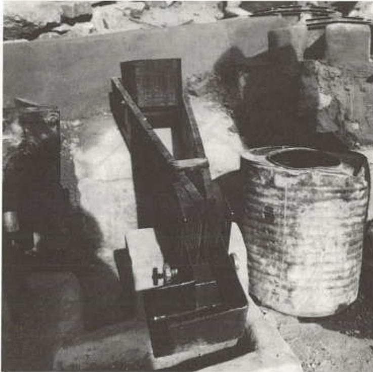
Canaleta en forma de abanico con revestimiento interior resistente al desgaste para la concentración de alimentación de minerales pesados, en una planta de beneficio boliviana de plomo zinc. Arriba, la alimentación; en primer plano, la lengüeta separadora regulable.
