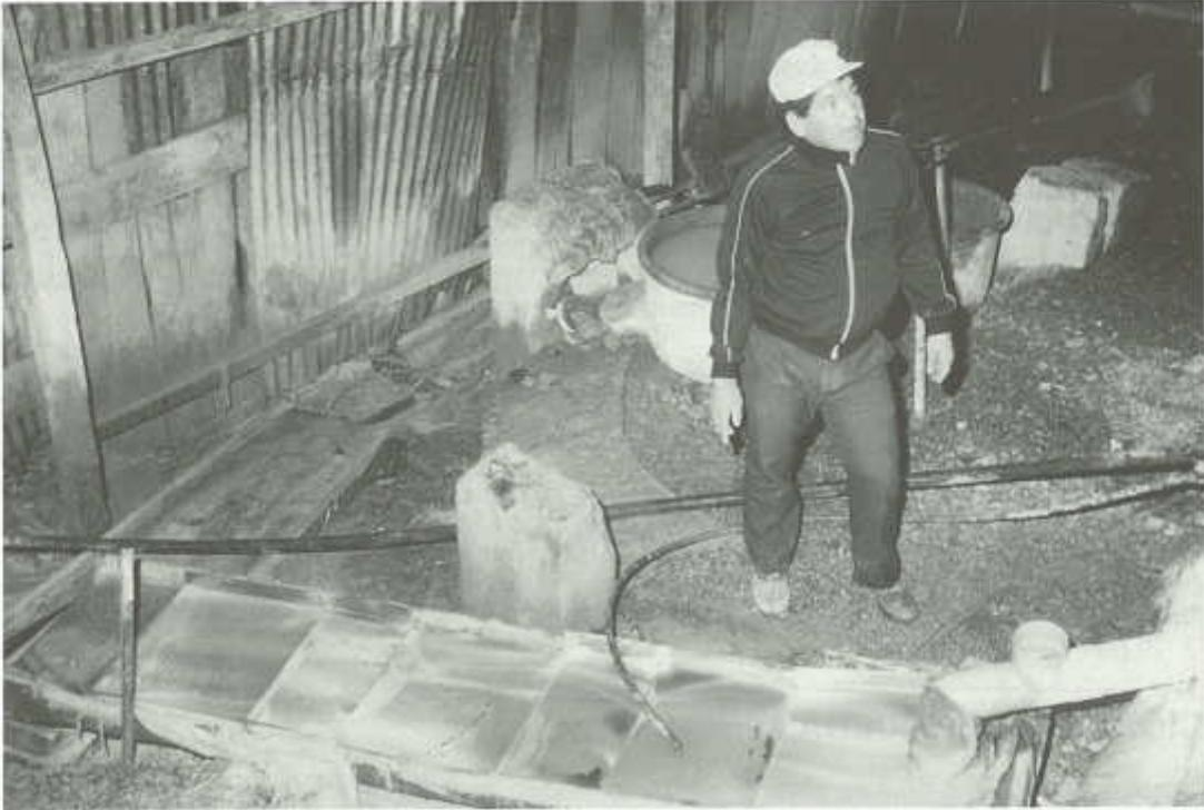
Placa de amalgamación con placas de cobre recubiertas de amalgama de plata para la amalgamación de oro fino de la pulpa guiada por encima. Nambija, Ecuador
