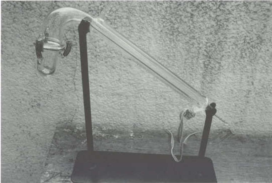
Retorta de vidrio para fines de demostración, de fabricación ecuatoriana. Se determinaron como problemáticos los resortes que durante el calentamiento de la retorta se deformaron y condujeron a fugas en el cierre. Luego fueron cambiados por un cierre de alambre fijo.
