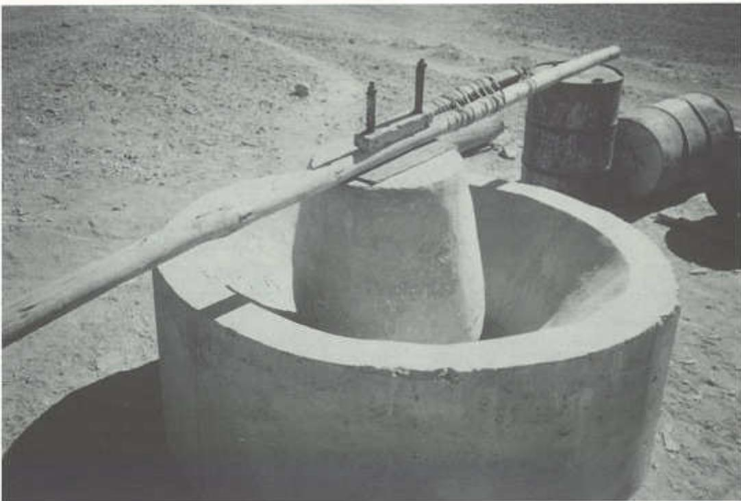
Triturador basculante (maray) para amalgamación simultánea de minerales de oro en una solera de hormigón con un cabezal de cemento manejado por una palanca de madera, Copiapó, II Región, Chile.
