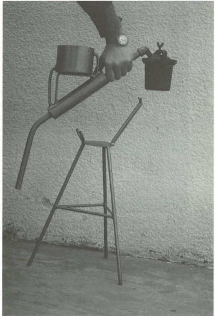
Retorta de fabricación ecuatoriana con circuito de refrigeración por convección y cierre a tornillo.
