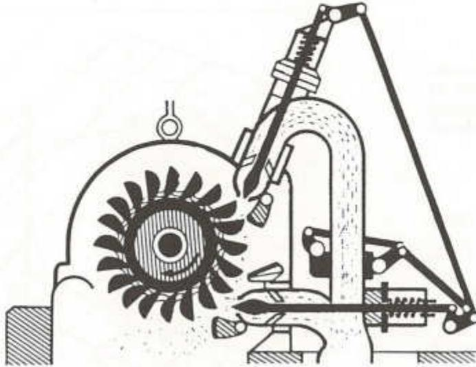
Dib.: Esquema de una turbina Pelton con dos inyectores, de Meier
