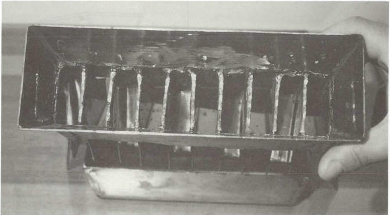
Vista de arriba, de la cámara separadora del partidor de muestras de fabricación colombiana.
