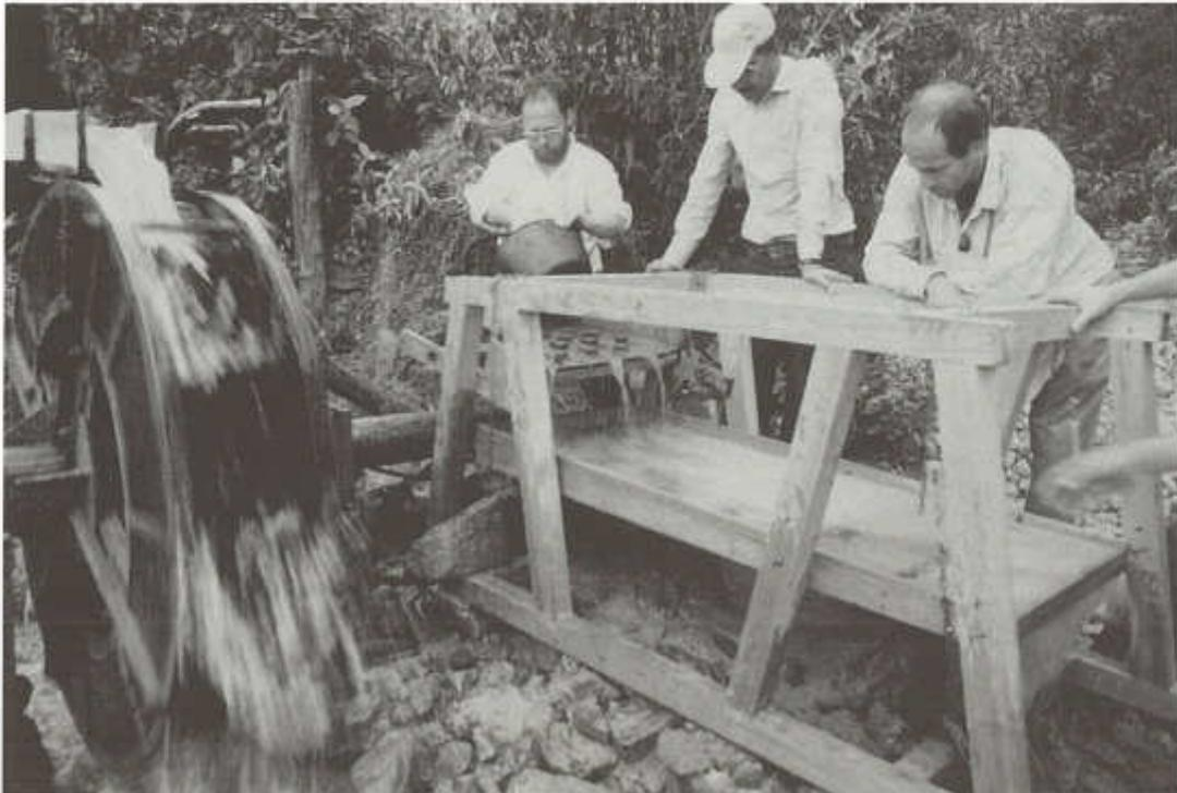
Mesa de concentración a golpe con rueda hidráulica como maquinaria motriz de construcción local para la concentración de minerales auríferos. En el fondo, la tabla de distribución para la homogeneización y distribución de la pulpa de alimentación. La Llanada, Nariño, Colombia.
