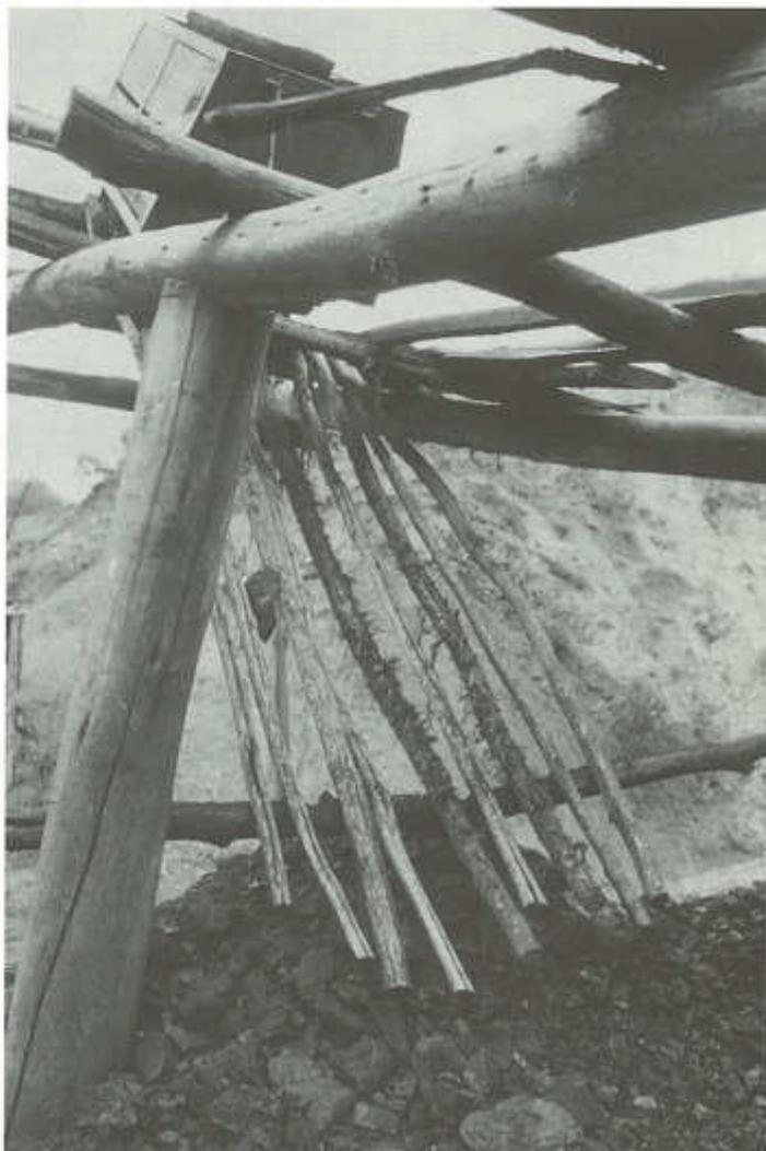
Criba de madera para tamaño grueso, para el desecho de carbón grueso bajo una rampa de descarga para carros metaleros de descarga trasera. Minería del carbón en la Región Río Checua, Cundinamarca, Colombia.
