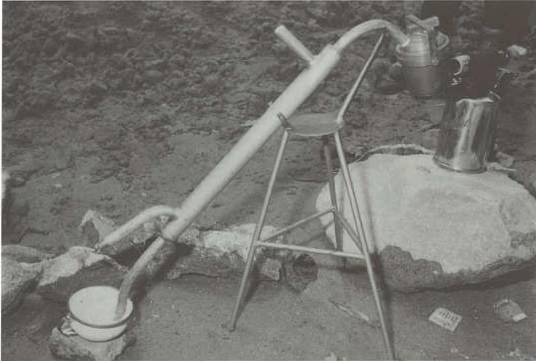
Modelo de retorta listo para su difusión, de fabricación colombiana, uso en campo con lámpara de soldar a bencina como fuente de calor y taza llena de agua para recolectar el precipitado de mercurio. El crisol está fijado mediante un cierre en cuña que va por un canal conductor. Esta clase de cierre es de fácil manejo y duradero. Precio de la retorta: alrededor de 110 DM.
