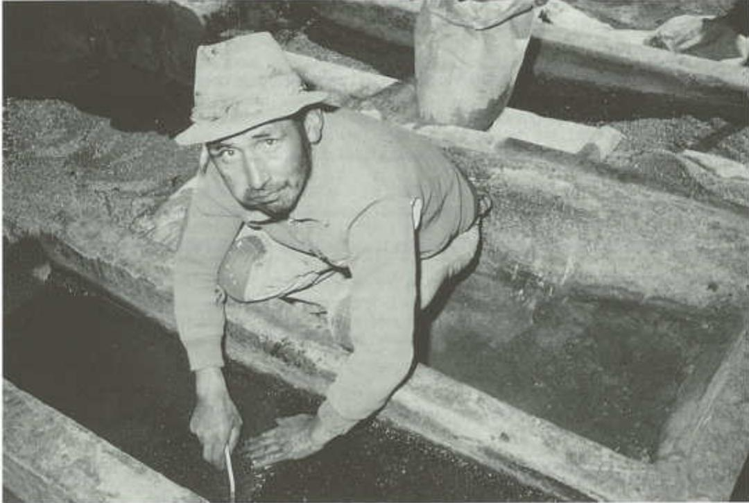
Flotación de sulfuros en una canaleta con piso de hierba para el lavado de concentrados óxidos de wolfram. Atrás, el material flotado extraído. Planta de beneficio Santa Rosa, Kami, Bolivia.
