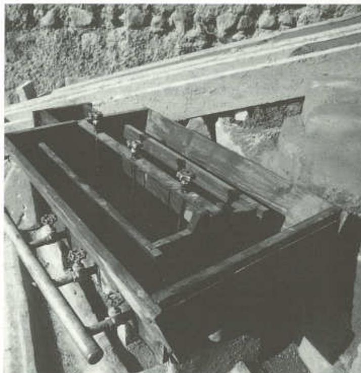
Hidroclasificador de corriente ascendente para la clasificación en medio fluido en tres clases de granos, de fabricación local en Bolivia. En la parte posterior, el cajón de alimentación; delante, la cámara de separación con rebalse de lama. A un lado, las instalaciones regulables separadas para la introducción de agua por la parte inferior. Arriba, la regulación de las llaves. Precio aprox. 500 DM. Planta Piloto de la Cooperativa Villa Imperial, Potosí, Bolivia.
