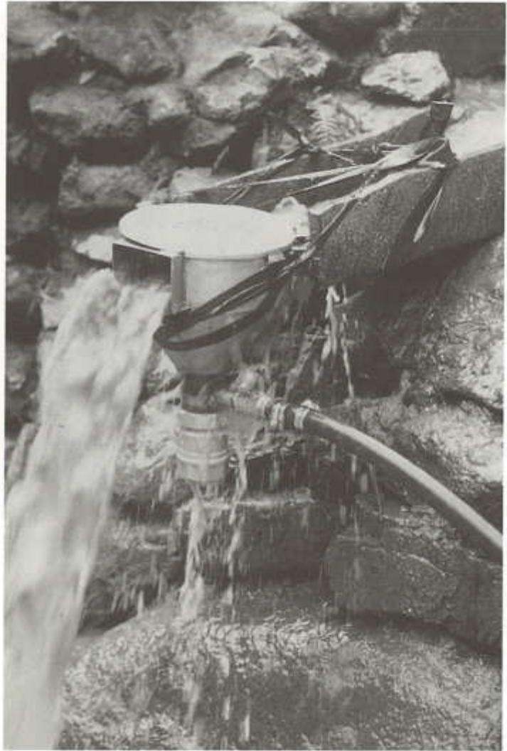
Trampa hidráulica para material pesado de fabricación local en Colombia. Es visible el grifo de bola para la regulación del agua de contracorriente. A la trampa para material pesado está conectada posteriormente una instalación de amalgamación. El rebalse es conducido a un recipiente de sedimentación para el deslame antes de una instalación de lixiviación por percolación. Mina Los Guavos, Nariño, Colombia
