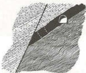
La explotación por bancos se aplica ocasionalmente para la explotación de porciones menores del yacimiento situadas debajo del nivel de extracción donde sería antieconómico trazar un nivel más profundo.
