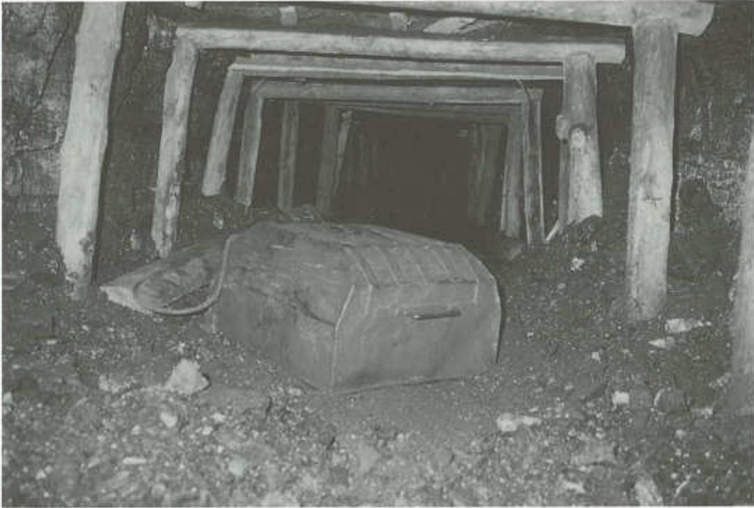
Trineo de arrastre para el transporte en explotación en una estratificación semilempinada (aprox. 30°). Vista de una chimenea asegurada con entibación de madera con unidades de marcos de dos estemples y cabezal. Minería del carbón en la región del Río Checua, Cundinamarca, Colombia.
