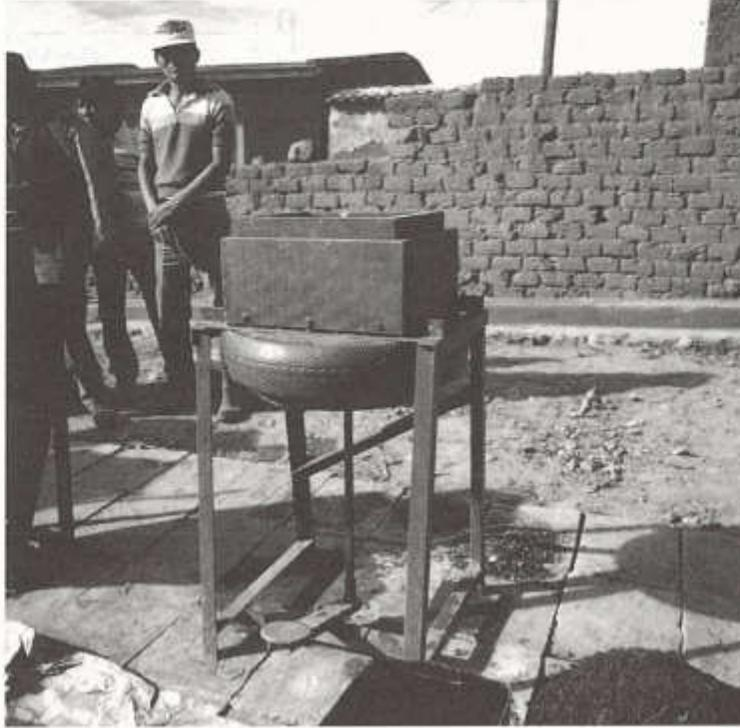
Prototipo de un maritate de pulsación a pedal con llanta de auto para bombear el agua de proceso, fabricado localmente, modelo de construcción Campo Nuevo, Bolivia
