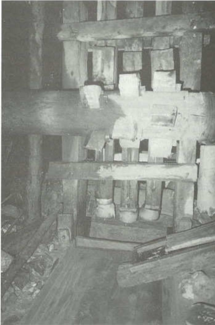
Batería de pisones de tres pisones con batea abierta. Se notan claramente las zapatas de hierro incorporadas, por encima el eje de la rueda hidráulica con las piezas de arrastre para los pisones. En primer plano, una mesa de lona sin la cubierta de paño. La Llanada, Nariño, Colombia.
