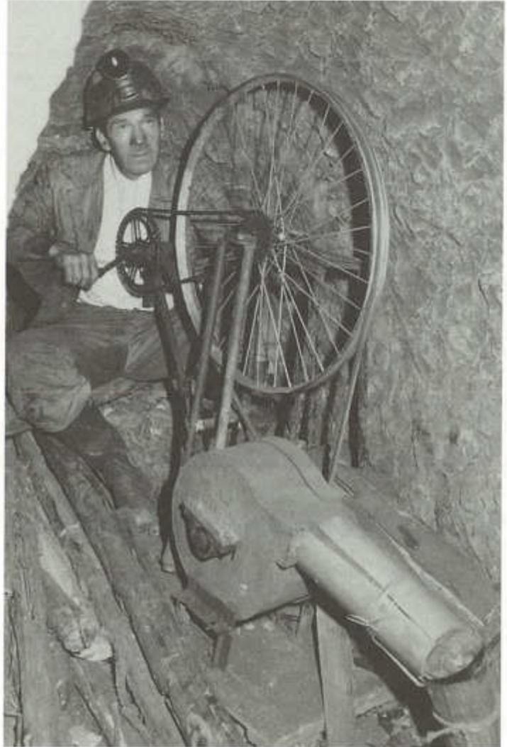
Ventilador manual para ventilación especial sopla con engranaje de correa y cadena de partes de bicicleta. Se hacen visibles las pérdidas de presión que reducen el rendimiento debido a la manga doblada en ángulo recto. Minería del carbón en la región del Río Checua, Cundinamarca, Colombia.
