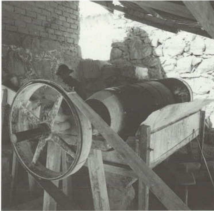
Trómel clasificador con engranaje a correa de un pequeño motor a combustión. Detrás del disco de transmisión la canaleta de alimentación la cual carga el material al interior del trómel. Beneficio de minerales de estaño en San Cristobal, Porco, Bolivia.
