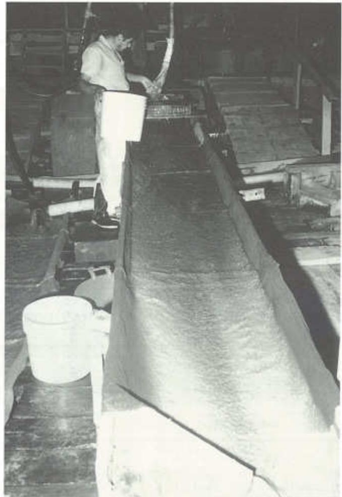
Mesa de concentración con cubierta de paño para la concentración de preconcentrados de minerales auríferos. Planta de concentración Portovelo, El Oro, Ecuador
