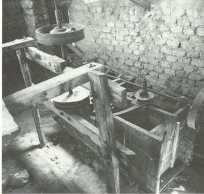
Celda de flotación de madera, de fabricación local. Arriba, el accionamiento de transmisión a correa para el mecanismo de agitación. A la derecha, el accionamiento de transmisión de las paletas para la extracción del float. La máquina era accionada por un pequeño motor diesel. Cercanías de Potosí, Bolivia.
