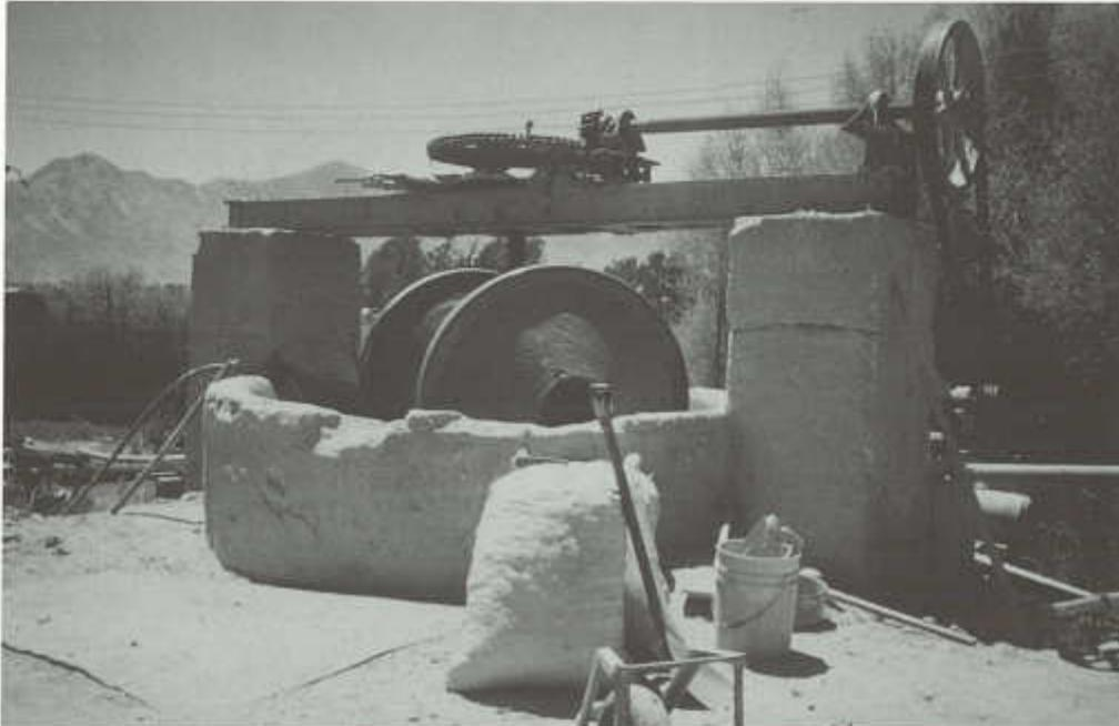
Vista total de un trapiche accionado por un motor eléctrico con transmisión a correa y engranaje cónico. Copiapó, III Región, Chile.
