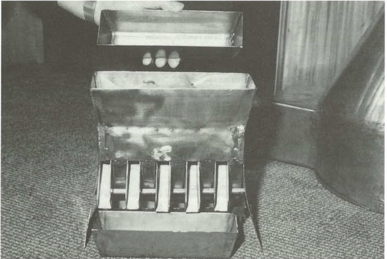
Vista de un partidor de muestras de laboratorio, de acero afinado con recipiente para la alimentación (arriba) y recipiente para sacar la muestra (abajo). El aparato es de producción colombiana. Precio aprox. 100 DM.
