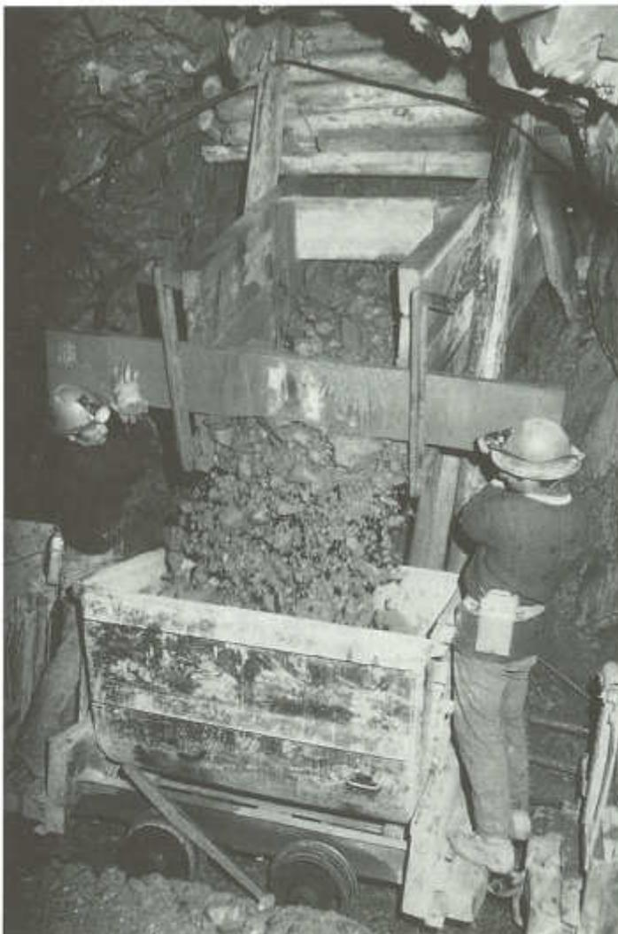
Tolva de buzón en el proceso de carga de un carro metálico. Mina de estaño Totoral, Oruro, Bolivia.
