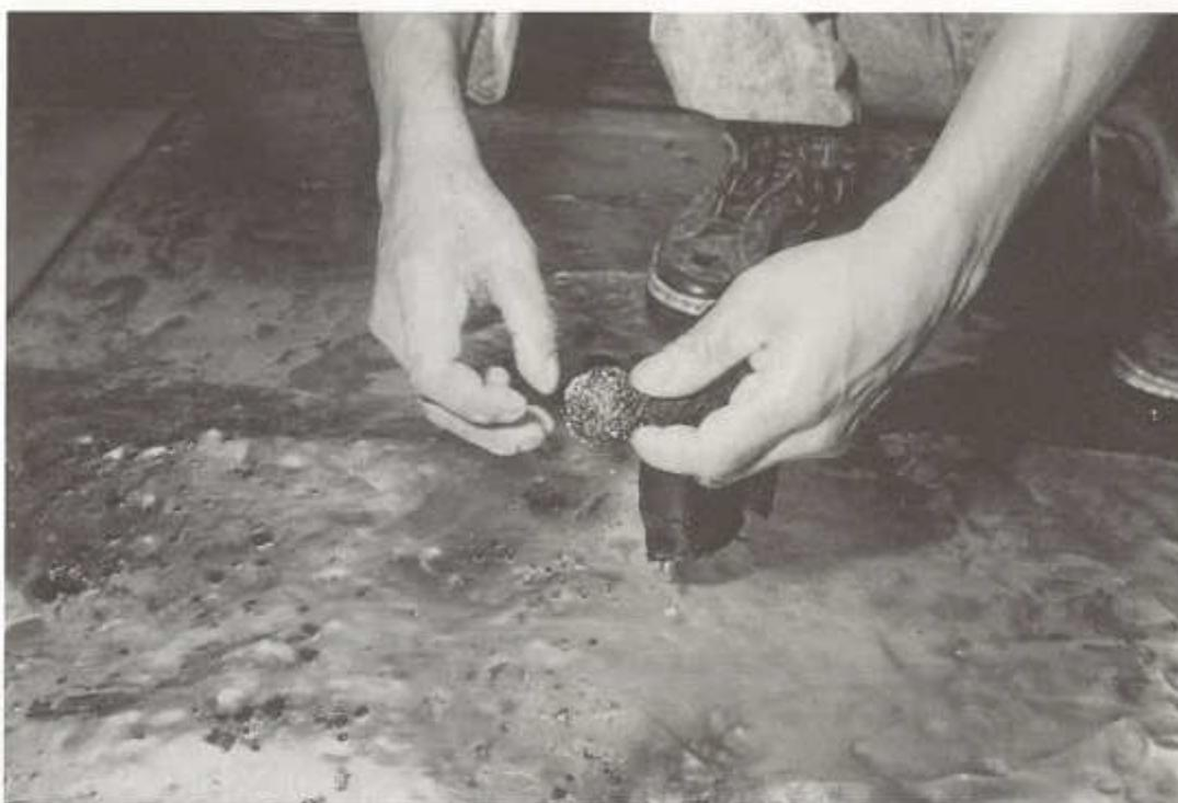
Cobertura de una placa de amalgamación con mercurio mediante el prensado del amalgama en una tela, Mina Los Guavos, Nariño, Colombia
