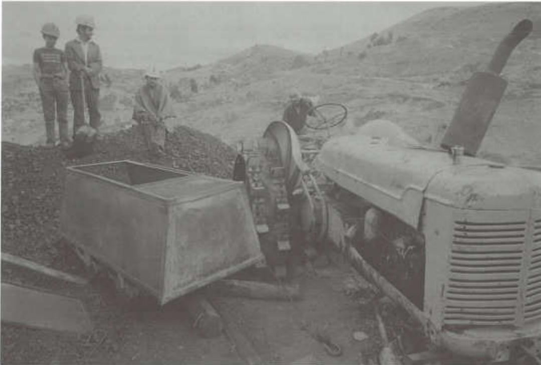
Chasis de tractor como máquina de extracción en una rampa y carro metalero rígido (de vaciado frontal). Minería del carbón en la región del Río Checua, Cundinamarca, Colombia.
