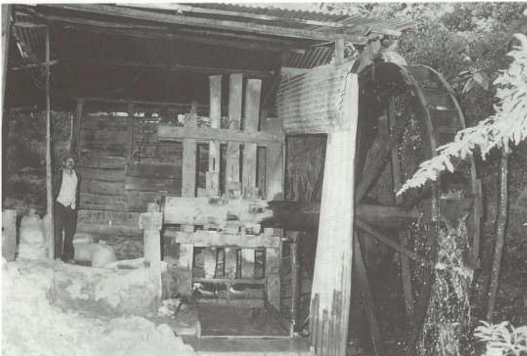
Batería de pisonos de madera con tres pisonos con rueda hidráulica de carga superior para la trituración de minerales de oro. La Llanada, Nariño, Colombia.
