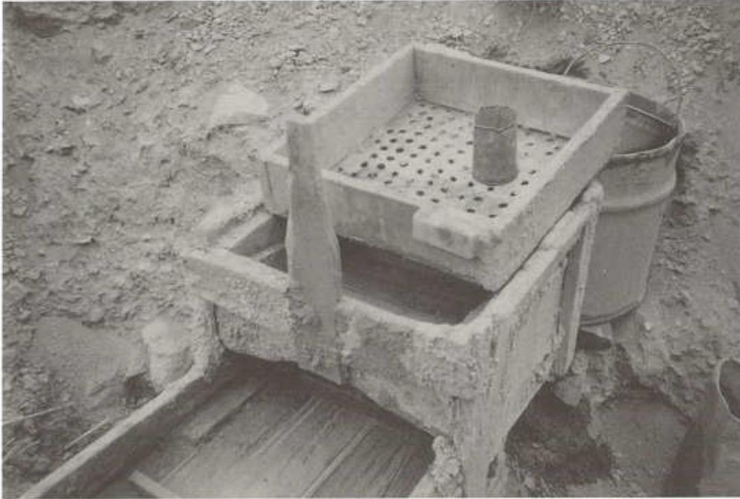
Vista en detalle de una cuna. Arriba es visible el cajón de la criba con plancha agujereada para la clasificación, debajo, la canaleta de alimentación. Abajo, la canaleta con trancas para la concentración. La palanca sirve para suministrar el movimiento a la cuna. Andacollo, IV Región, Chile.
