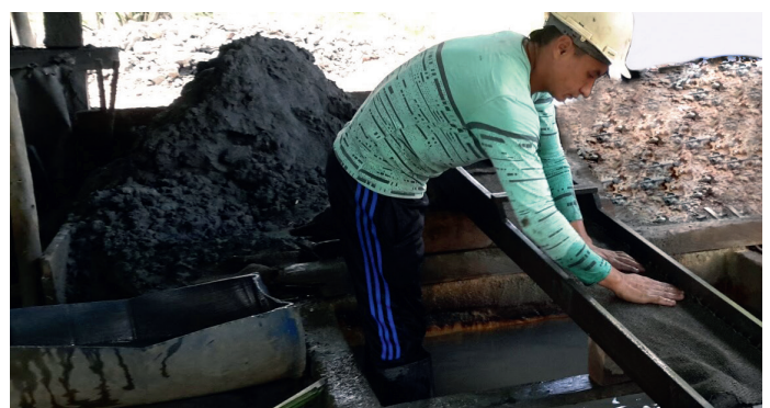
Canaleta para concentración gravimétrica de oro
